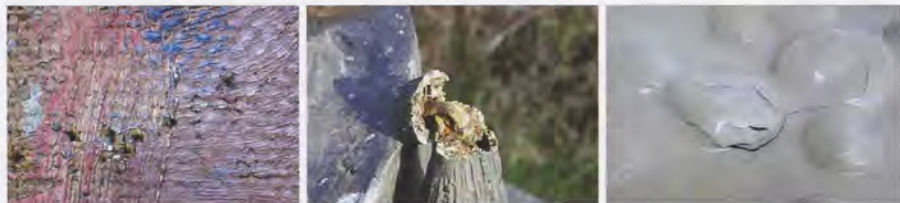
Poškodbe – detajli: luknjice od lesnih insektov na površini slike, korozija na odlomu bronaste skulpture, poškodovan kavčuk (Foto: Nada Madžarac)
