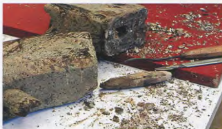
Poškodbe zaradi delovanja lesnih insektov (Foto: Bojan Nedok)
