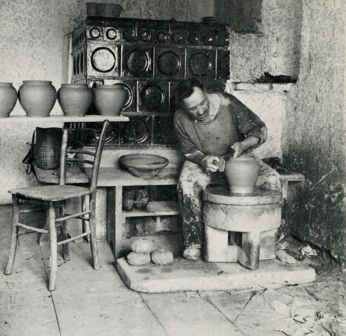
Lončarski kolovrat — »kalurat na mataruge« (Frac Pogorelec, Dolenja vas pri Ribnici) foto leta 1959
