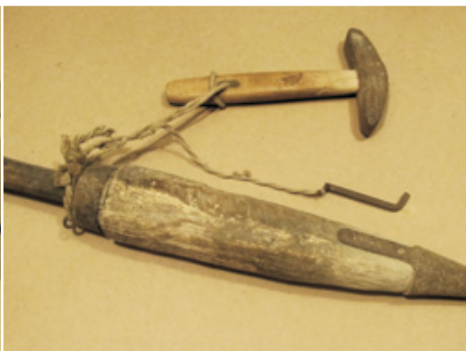
Klepilo, kladivo "mlat" in ključ za nagib kose. Orodje za ostrenje kose.
