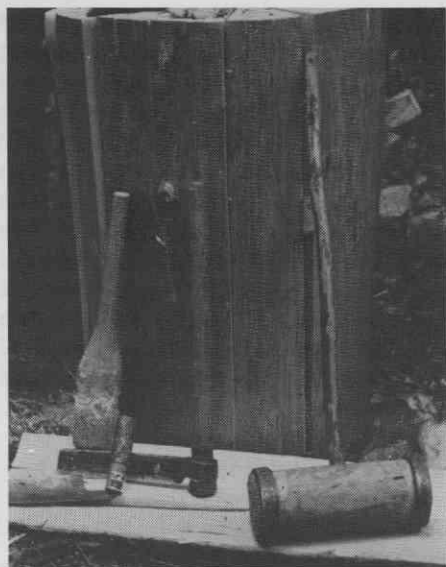
Sl. 1 — Orodje za cepljenje skodel v kočevskih gozdovih — Foto: F. Šarf, 1975
