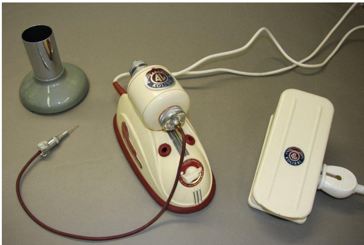
Slika 20: Strojček za popravljanje najlonk (foto: Ana Motnikar)
