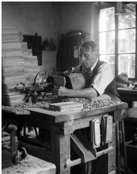
Vrtanje lukenj v lesne osnove za ščetke ribarice v Nagličevi delavnici leta 1932 (foto: Peter Naglič)
