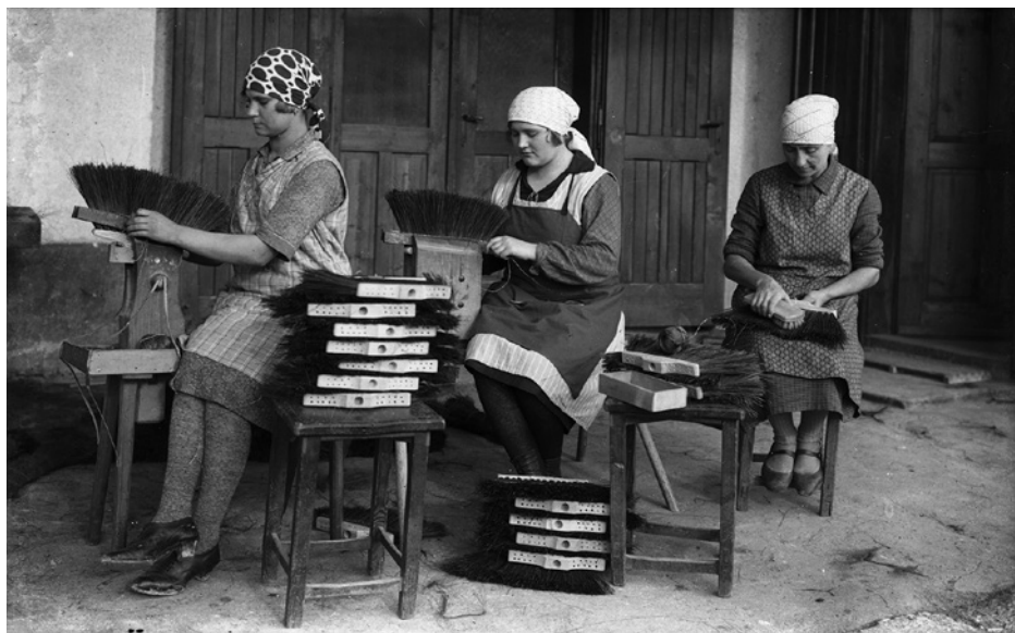
Nagličeve delavke okoli leta 1930 pri šivanju piasavinih vlaken metle »Record« na dvorišču tovarne v Šmarci (foto: Peter Naglič)
