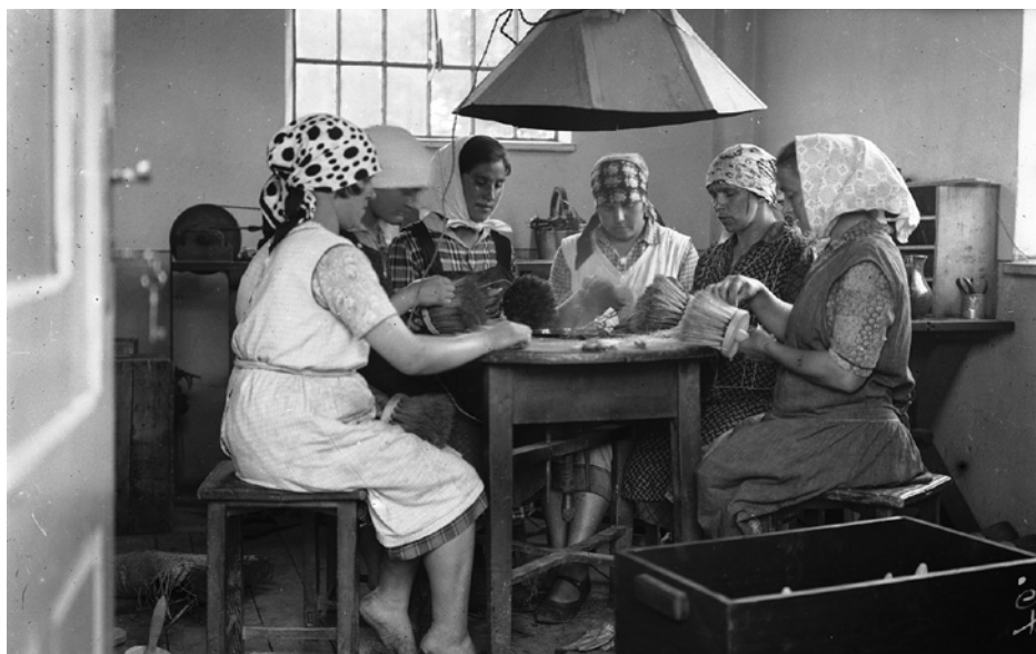
Delavke Nagličeve tovarne leta 1930 pri »smolenju« – vstavljanju v smolo pomočenih ščetin v izvrtine lesnih osnov belilnih čopičev (foto: Peter Naglič)
